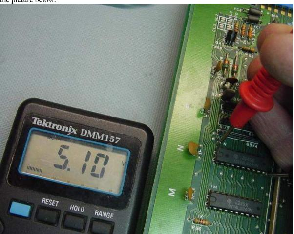
THE VOLTAGE READING SHOULD BE NO LOWER THAT 4.75VDC.
